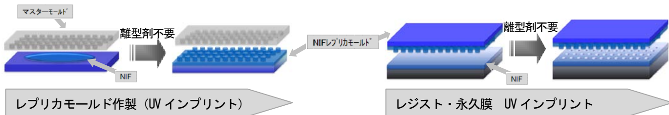
図2. NIF レプリカ / NIF レジスト&永久膜 離型剤フリーUV ナノインプロセス
