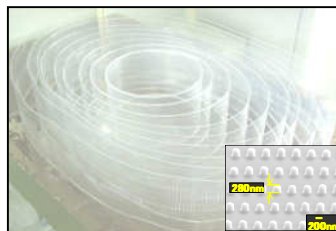
転写PSシートの外観 (転写幅: 150mm、連続転写長さ: 15m)
