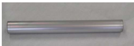
図6 微細微細構造制御めっき SUS304 中空ロール(電気Niめっき 3\mu\text{m} )
